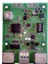
Scheda interfaccia modbus GTW-08 cod. A7721982
