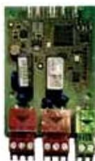
Scheda interfaccia modbus GTW-08 cod. A7721982
