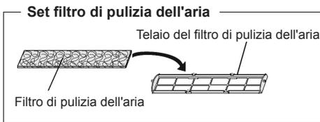
② Agganciare il fermo su entrambe le estremità del filtro ai due ganci sulla parte posteriore del telaio del filtro di pulizia dell'aria.
