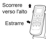
① Montare il Supporto. ② Fissare il Telecomando.
